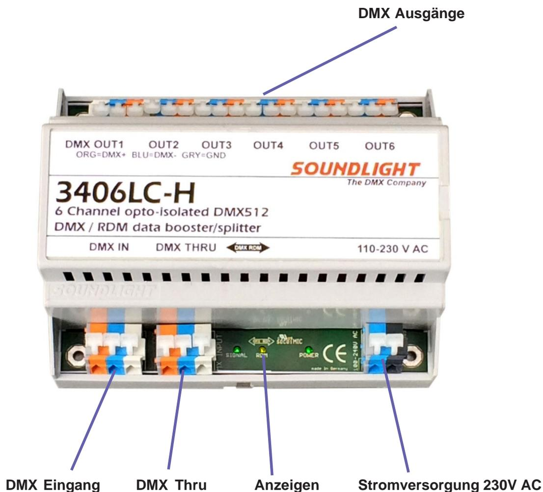
Der Booster/Splitter ist ein- und ausgangsseitig mit Klemmen bestückt. Jeder Klemmanschlußblock verfügt über drei Klemmen für die normmäßige Belegung gemäß USITT DMX512/1990, DIN 56930-2, ANSI E1-11 und ANSI E1-20:
